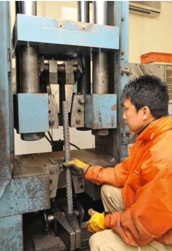
碳鋼鋼筋的拉力測試
