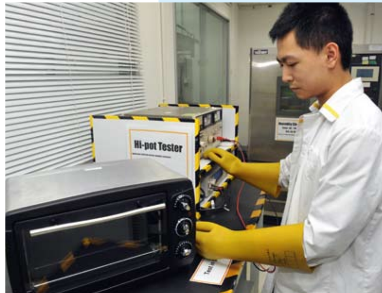
量度玩具聲量 為電烤爐進行電氣強度試驗，確保使用安全
