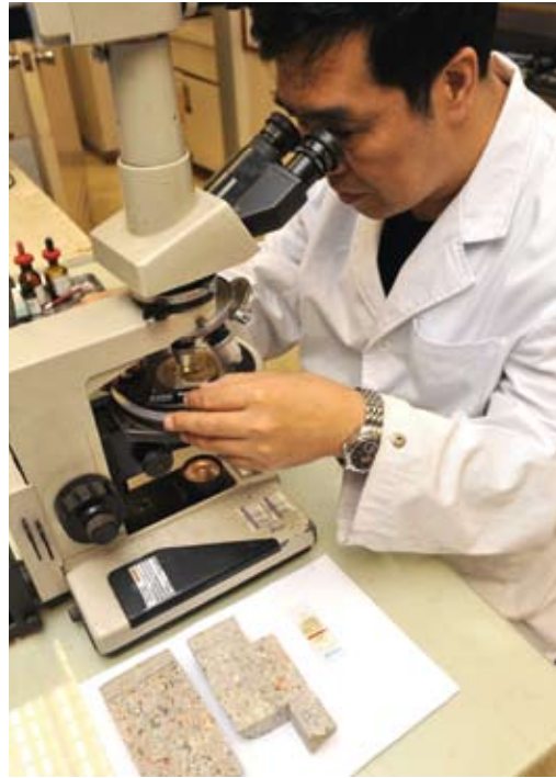
利用顯微鏡進行岩相檢測，評估硬化混凝土的品質
