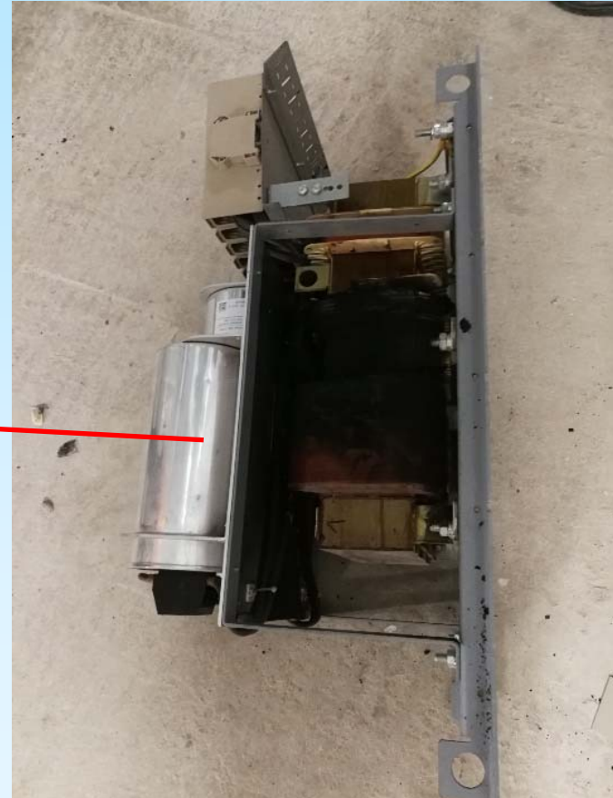
故障的電源濾波器
