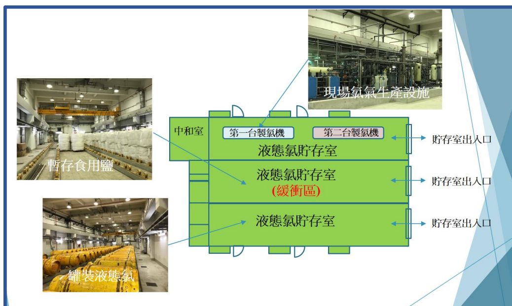
圖(三) - 牛潭尾濾水廠氯氣大樓平面圖
