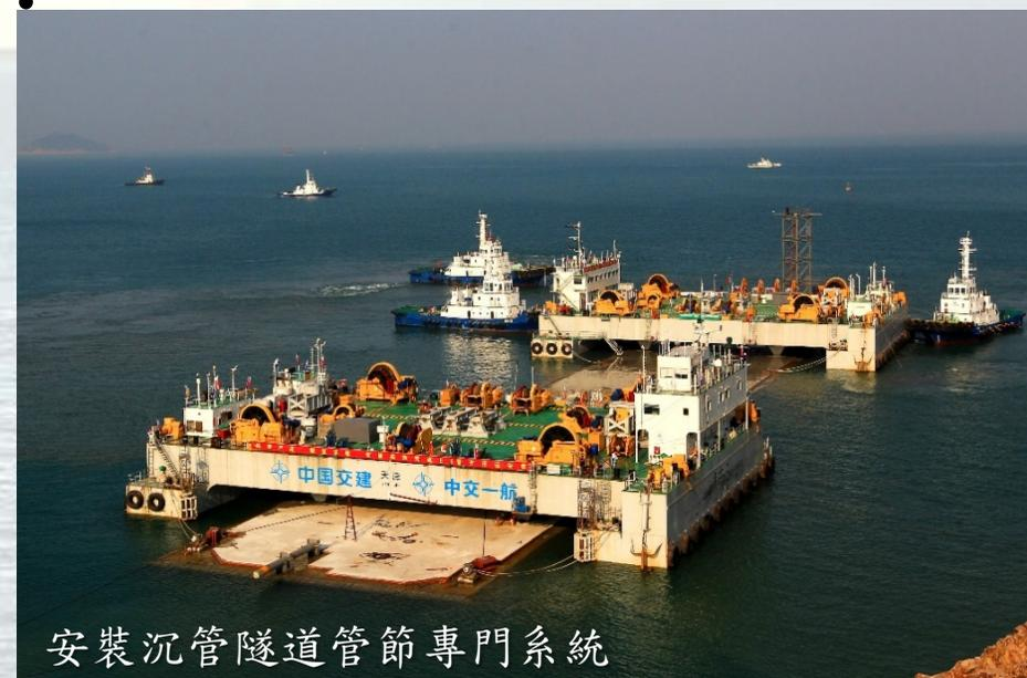
安裝沉管隧道管節專門系統
