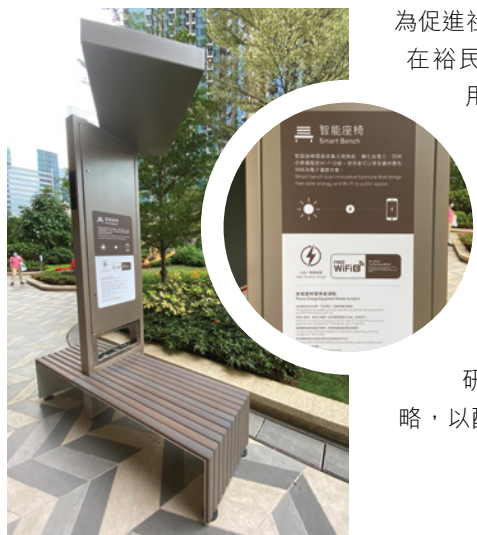
設置於裕民坊商場的智能座椅，可從太陽能板收集能源轉化為電能，替手提電話充電。
