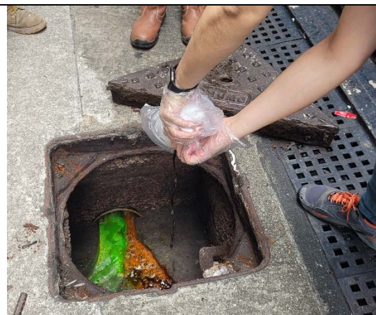
在後巷進行污水渠錯駁調查，透過加入色水追縱污染源。
