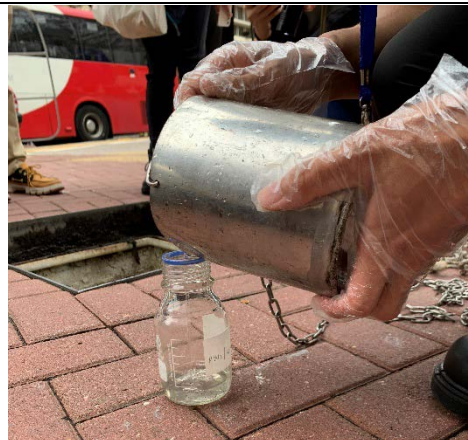
在後巷進行污水渠錯駁調查，透過加入色水追縱污染源。
